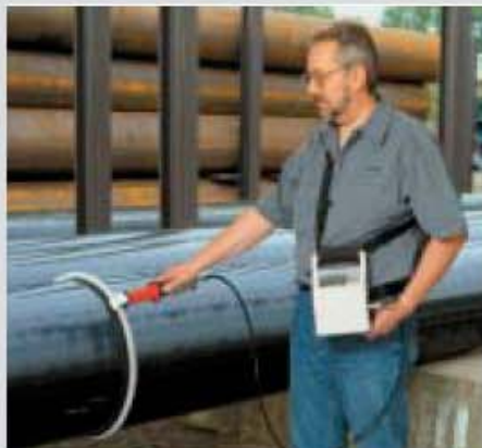
Détection des pores aux oléoducs
