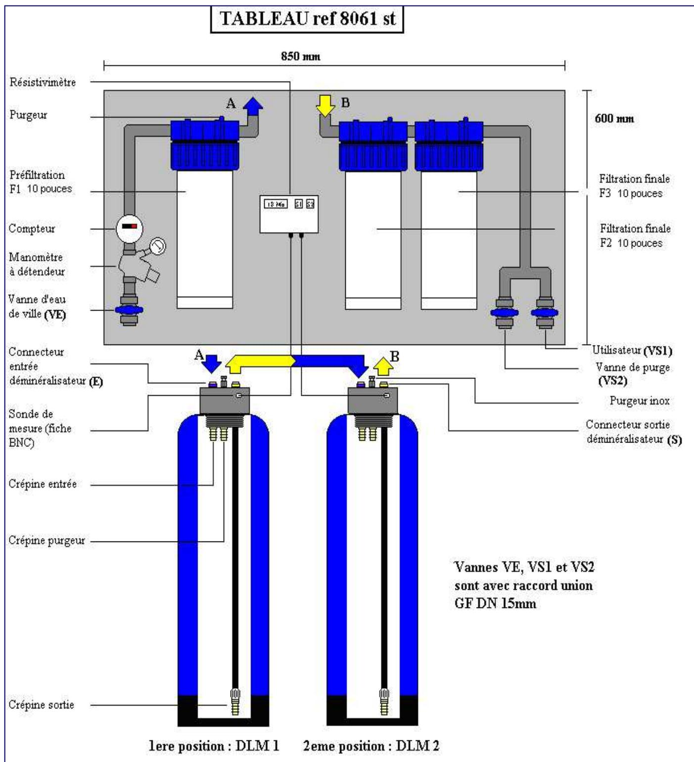
1/ Avant tous raccordements sur notre installation, purger à l'égout la canalisation d'eau froide servant à alimenter l'installation jusqu'à ce que l'eau coule claire afin d'éviter le colmatage des filtres dû aux dépôts dans la canalisation
