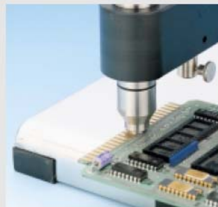
Mesure d'une couche d'or sur un circuit imprimé avec GalvanoTest 3000
