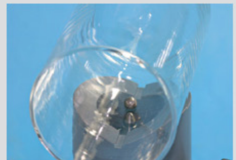
Les billes de référence spécialement traitées assurent une reproductibilité maximale des mesures.
